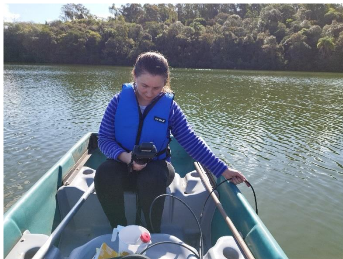
Figura 03: Utilização da Sonda multiparâmetros da marca Horiba e modelo U-52G. Fonte: Dos autores, 2022.
