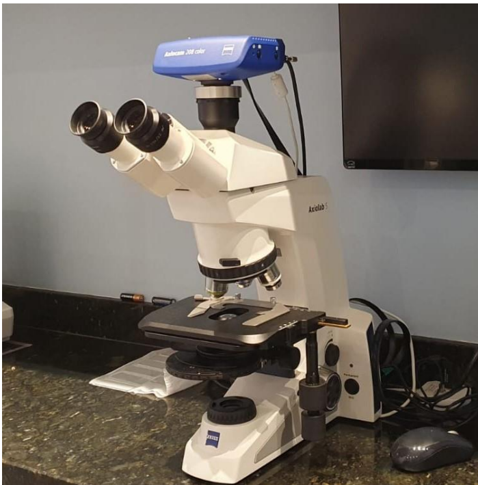
Figura 1: Microscópio utilizado no estudo de avaliação das bactérias filamentosas presentes nas amostras de lodo e espuma
