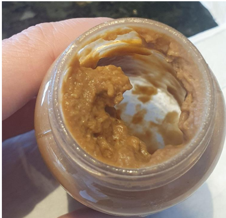
Figura 3: Amostra da espuma do tanque de aeração proveniente da indústria de carne suína.
