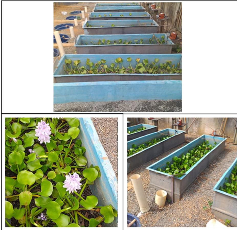
**Figura 1: Sistemas Alagados Construídos utilizados. Fonte: Próprio autor.**
