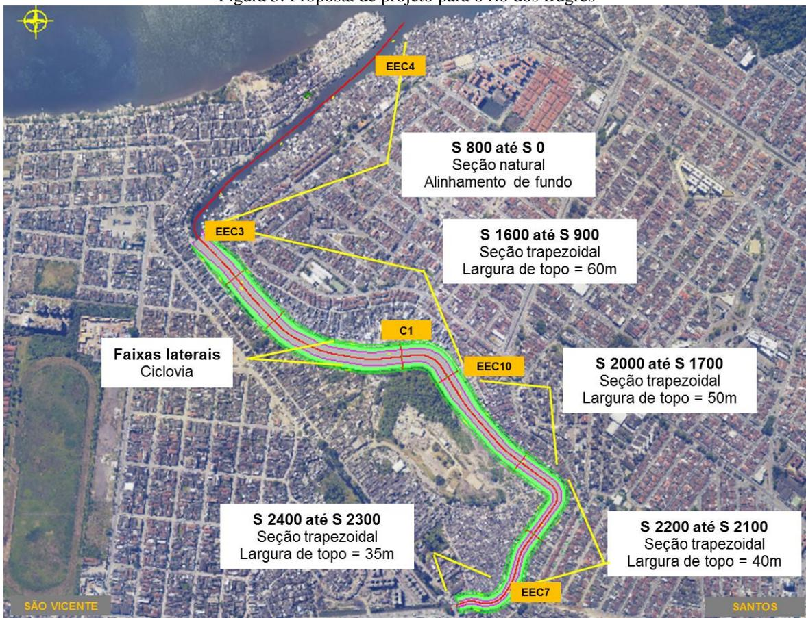
Os estudos geotécnicos demonstraram que é possível manter a estabilidade do canal desde que mantida a seção trapezoidal com talude de 1:5. Por meio das amostras e sondagens, verificou-se que o solo é mais instável, com a presença de mangue em algumas áreas. Desta forma, a inclinação do talude proposto obedece ao estudo de estabilidade realizado, a fim de se garantir o mínimo de alterações no aterro ao longo do tempo.
