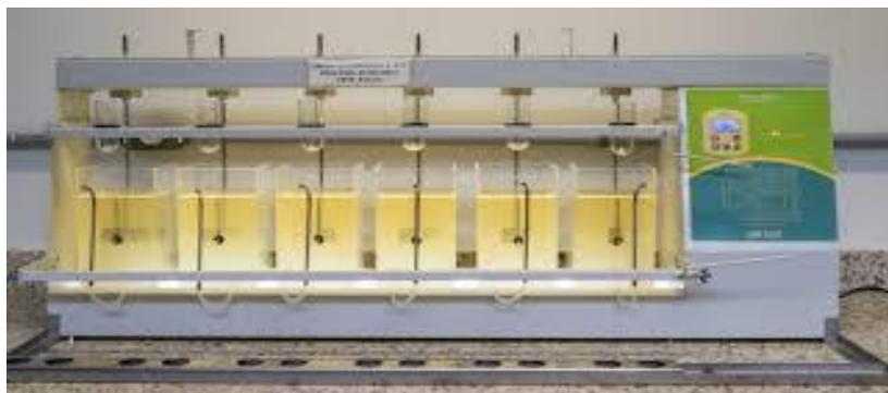
**Figura 3. Ensaio de Jarteste em equipamento com 6 Jarros.**
