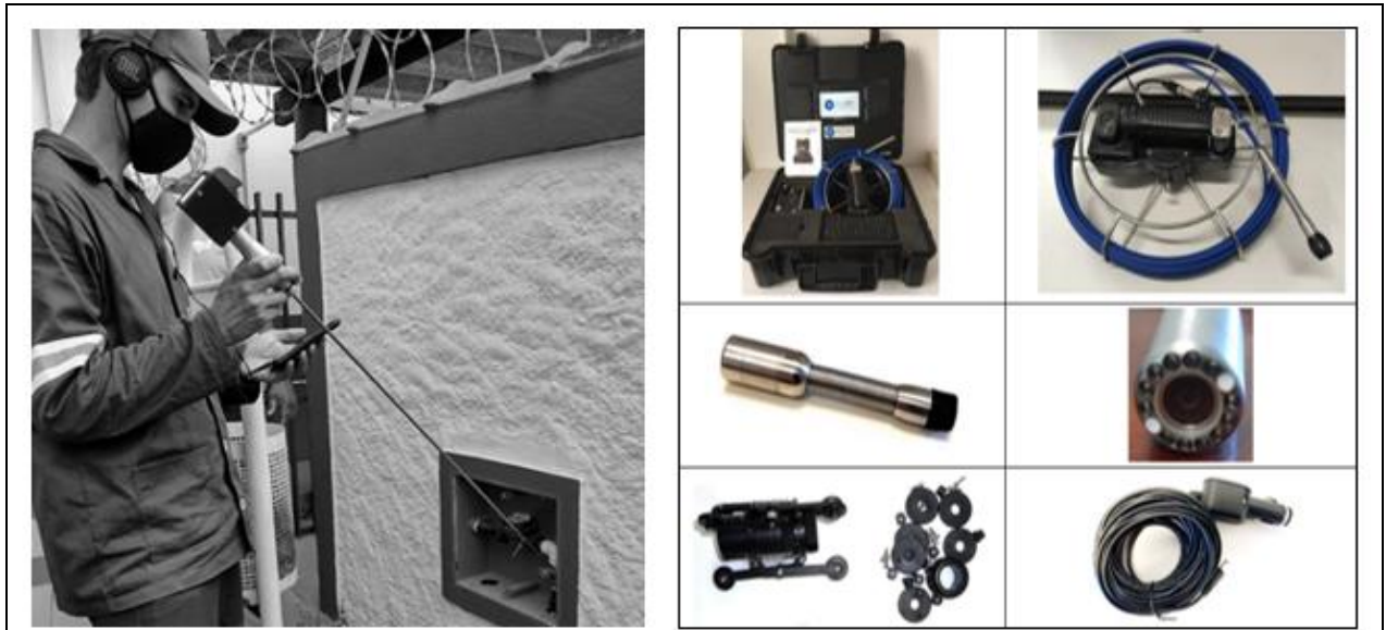
Fig 4 – Pesquisa de vazamentos não visíveis – Sistema automatizado
