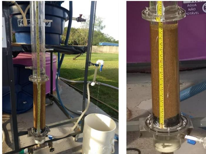
**Figura 1: Unidade piloto de filtração direta descendente.**
