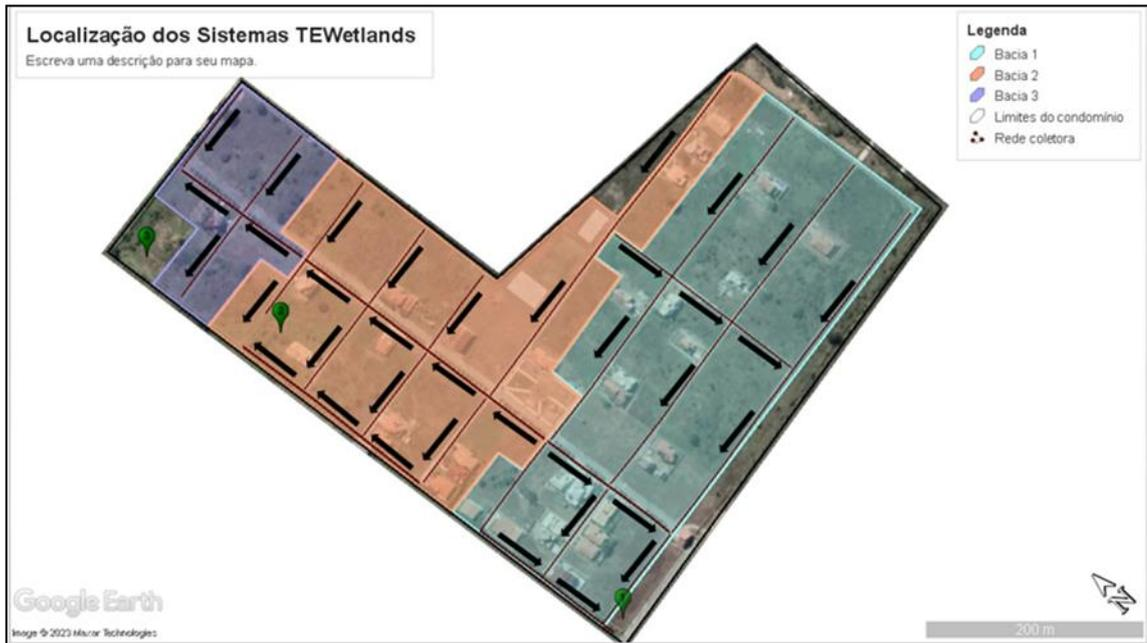
**Figura 5: Determinação das Bacias de Contribuição e locação das Centrais de Tratamento. Autores (2023)**
