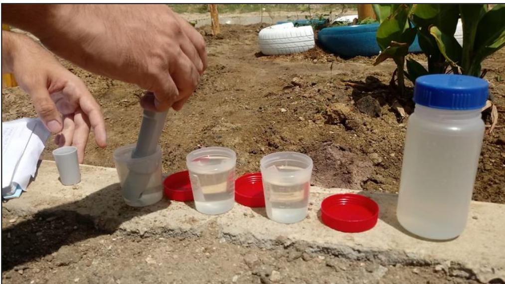
**Figura 2: Efluente gerado pelo protótipo do TEWetland construído em Ingá, PB. Acervo do LABEA/UFPB (2022)**
