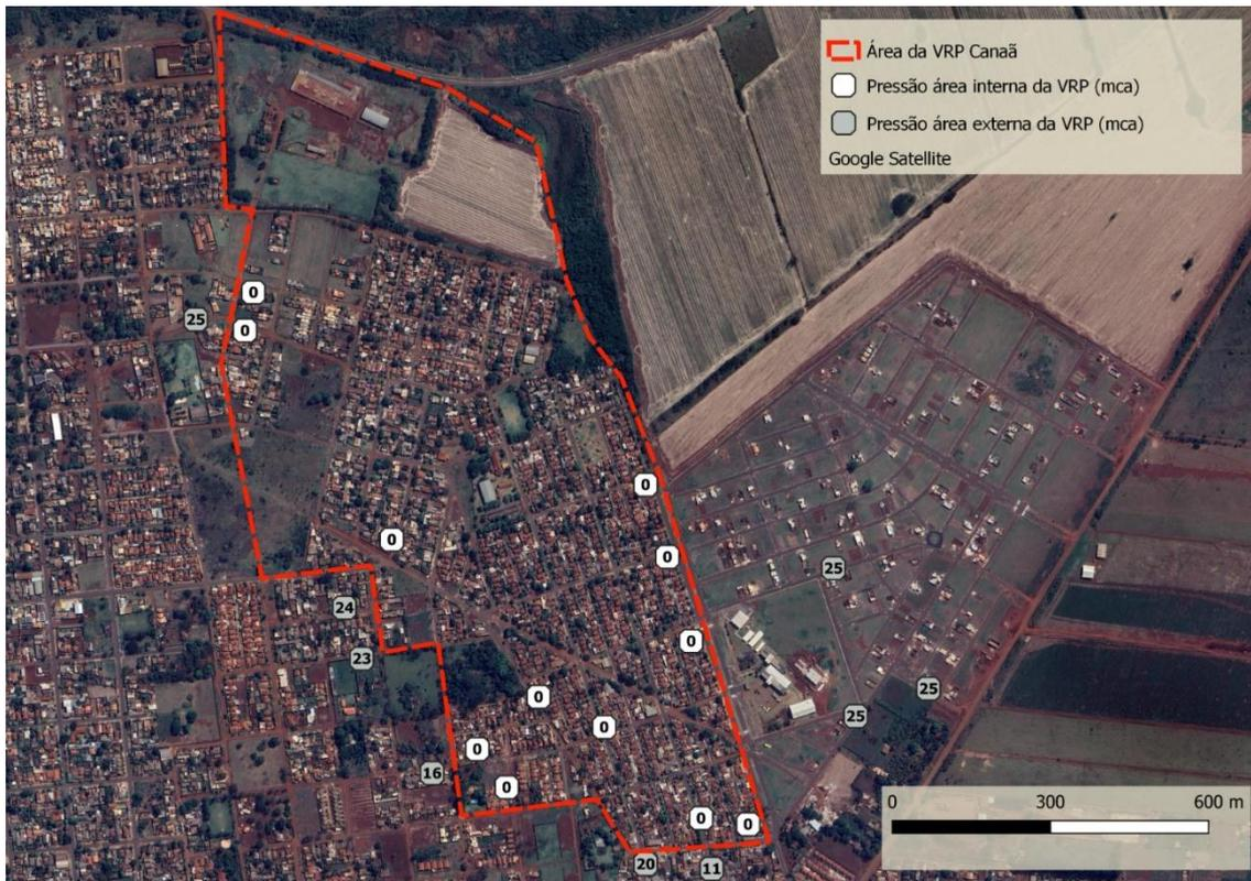
Figura 8: Teste de estanqueidade na área da VRP Canaã I
