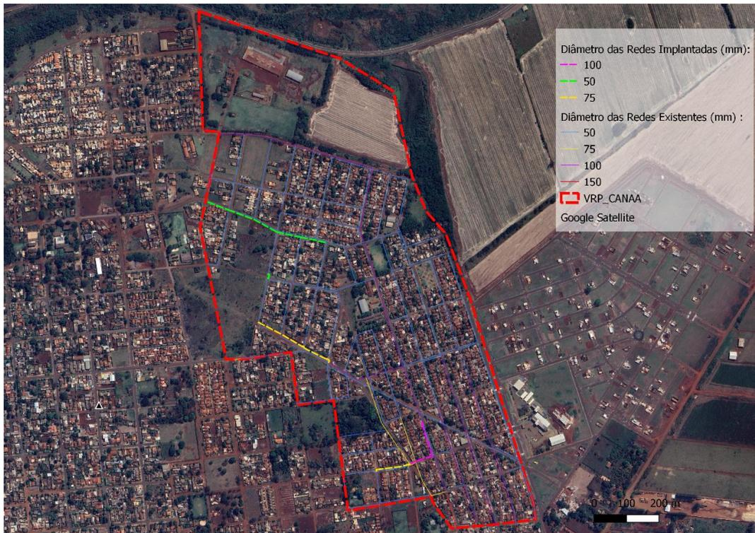
**Figura 6: Redes de distribuição de água implantadas**
