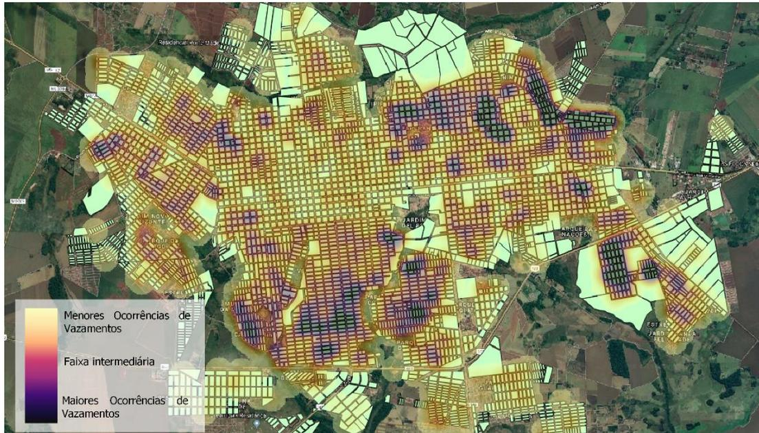
**Figura 1: Ocorrência de vazamentos monitorados pela SANESUL para o município de Dourados/MS (adaptado de TR, 2020)**
