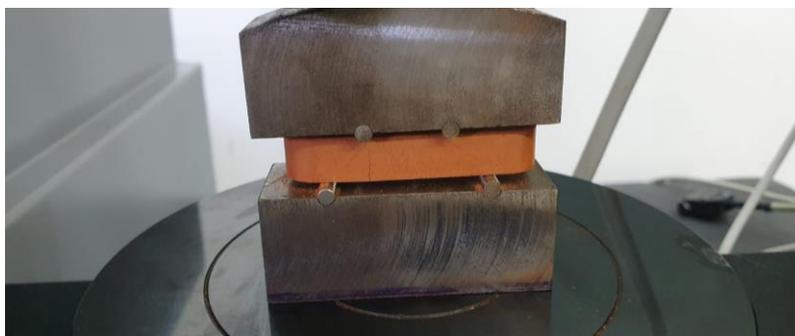
Figura 2: Exemplos de ensaio com EMIC com detalhe da ruptura na amostra.
