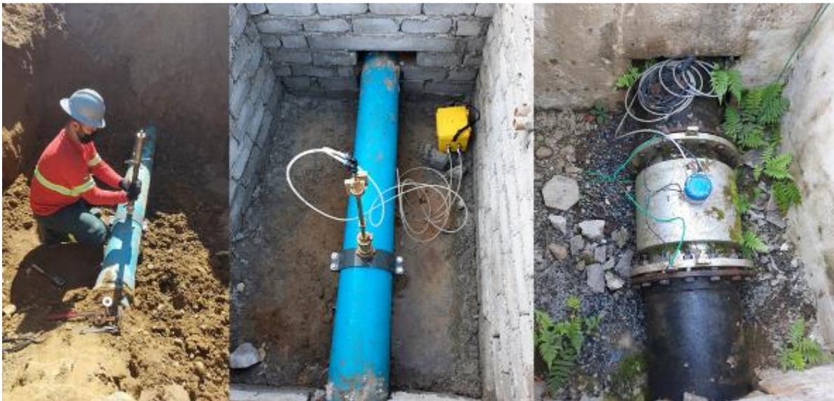
Figura 2: Detalhes da instalação do TAP, tubo de Pitot com maleta diferencial e macromedidor eletromagnético verificado pelo procedimento.
