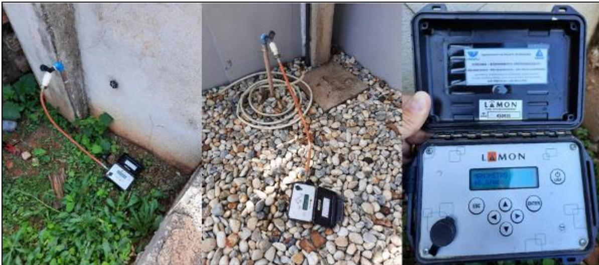
Figura 4: Detalhes da instalação dos dataloggers para monitoramento de pressão no bairro Schroeder I.
