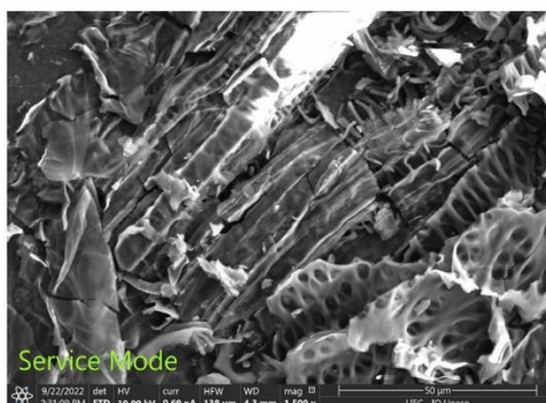
Figura 10 – Imagem MEV do biocarvão BMA2 à escala de 50 micrômetros e ampliação de 1.500X.
