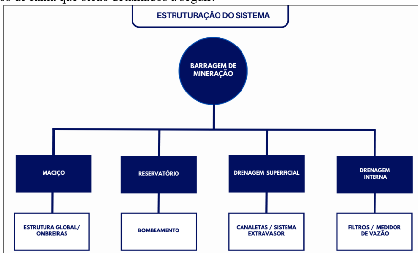
Figura 1: Estrutura do sistema, subsistemas e componentes de uma barragem de mineração hipotética.
