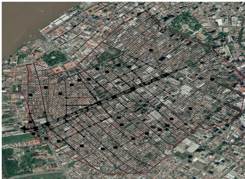
Figura 2: Sub-bacias que contribuem para o escoamento pluvial até o canal da Tamandaré no SWMM.
