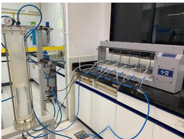
**Figura 2 - Vista geral da unidade de Jarteste adaptada para flotação**
