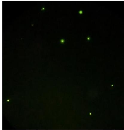
**Figura 7 - Microesferas visualizadas por microscopia de fluorescência – Aumento 100x**
