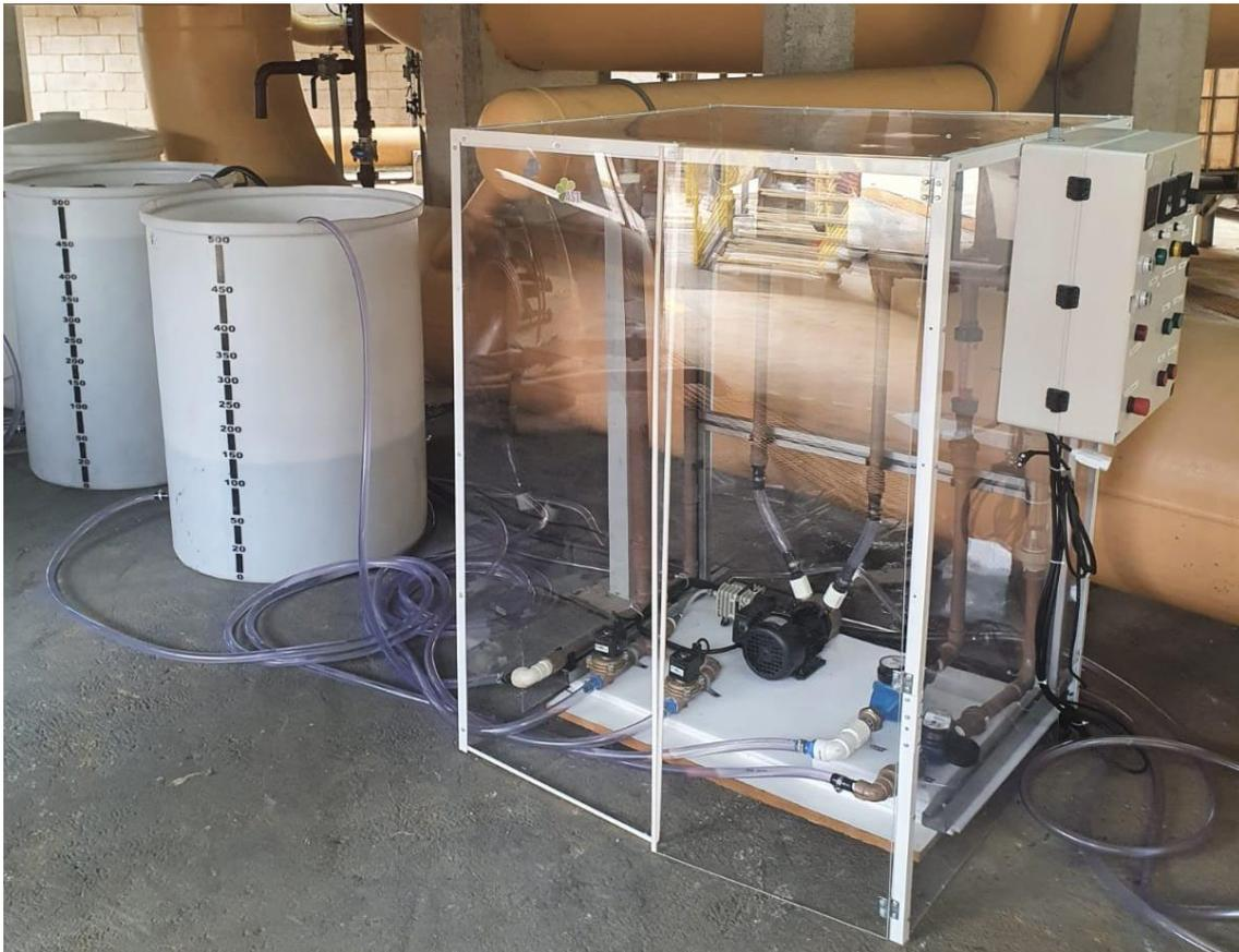
**Figura 1 - Piloto de Ultrafiltração com membrana modelo: AQUA-MEM**
