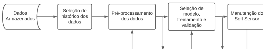
Figura 1: Metodologia de construção do Soft Sensor – Kadlec et al. , 2009 (adaptado).
