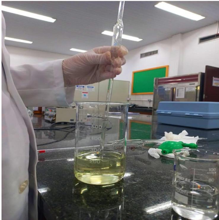
**Figura 3: Preparação do reagente combinado para o ensaio de Fósforo Total**
