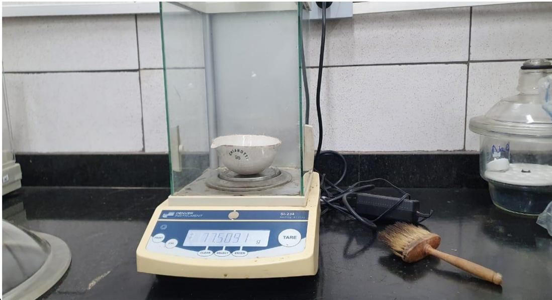
**Figura 4: Balança analítica**
