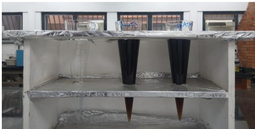
**Figura 5: Amostras durante o ensaio de sólidos sedimentáveis**
