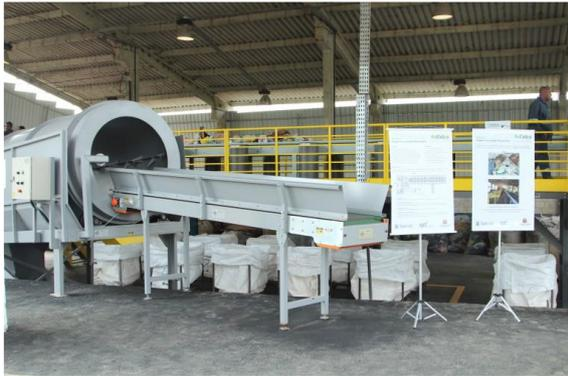
a) Sistema de segregação mecanizada
