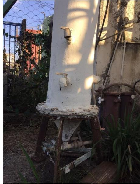
**Figura 4: 1ª e 2ª torneiras de pontos de coleta de lodo anaeróbio, com sólidos mais granulados, Fonte: Autoria própria**
