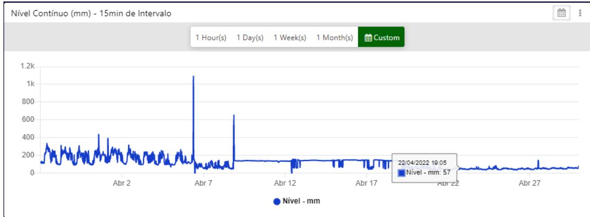
**Figura 4: Gráfico de medição de nível no mês de abril/22 do sensor instalado no PV da Rua Antonio de Barros**
