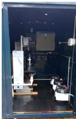
**Figura 4 – Estrutura de instalação das sondas e equipamentos de armazenamento e transmissão dados**
