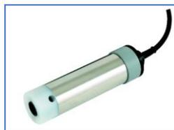
**Figura 2 – Sonda de Turbidez**
