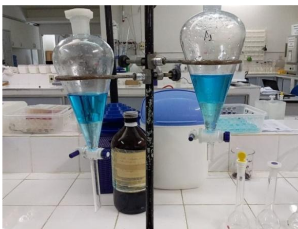
Figura 3: Aparato experimental da extração líquido-líquido
