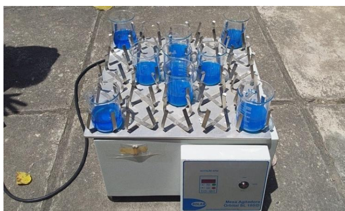
Figura 1: Mesa agitadora contendo as amostras sob a irradiação da luz solar
