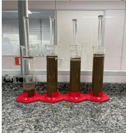
**Figura 2:** Sistemas de contaminação do solo. À esquerda a coluna controle seguida das três colunas de contaminação.
