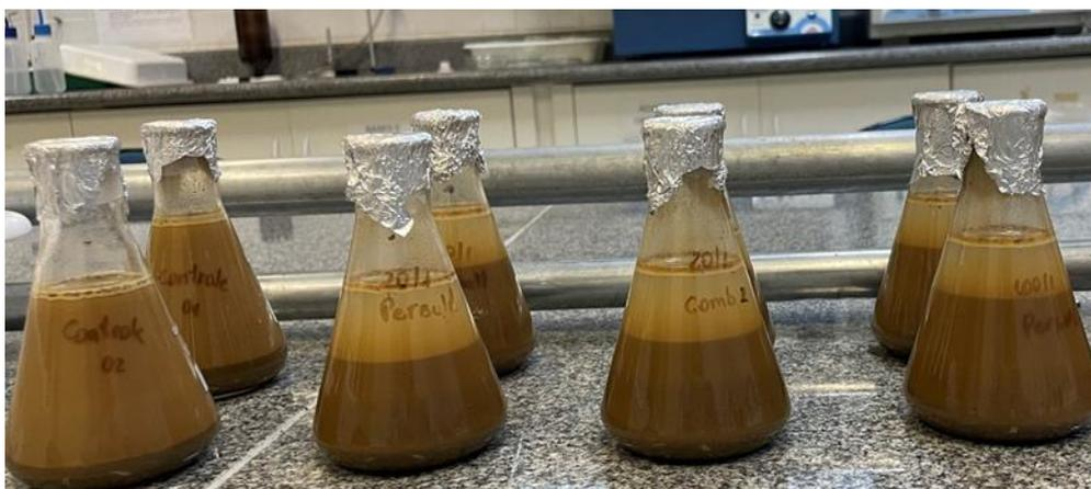
**Figura 5: Sistema de remediação em batelada em erlenmeyers.**
