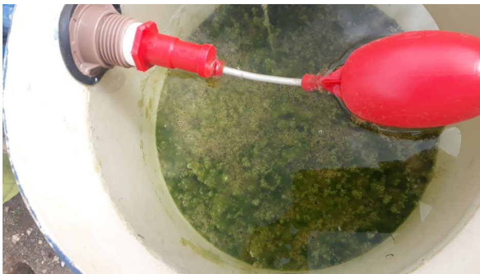
Figura 7: Biofilme no FL no trigésimo segundo dia de operação.
