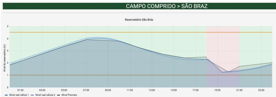
Figura 3 - Curvas de observação (dados reais) e previsão (via plataforma de inteligência artificial) para um reservatório em operação no tramo do sistema de abastecimento de água sob avaliação.
