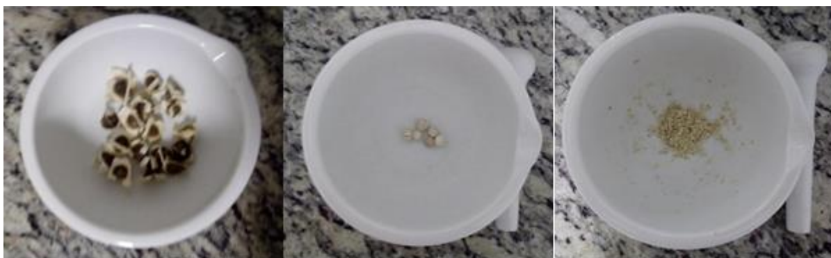
Figura 3 - Processo de trituração das sementes sem casca de Moringa oleifera
