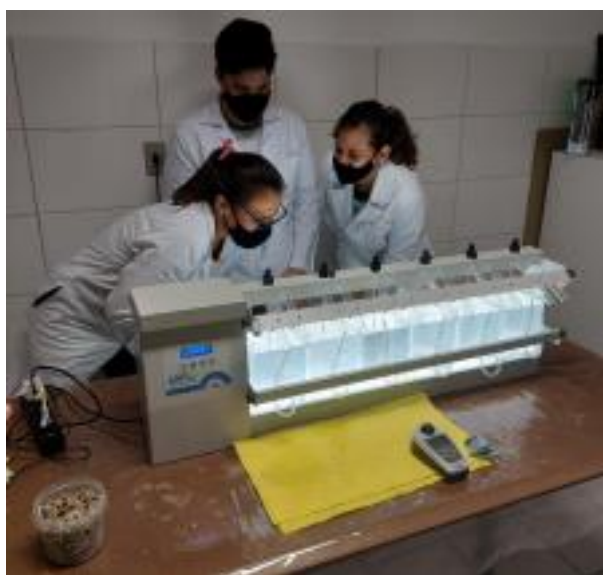
Figura 1 – Equipamento jartest utilizado nos testes experimentais.
