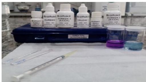
Figura 5. Kit titulométrico utilizado para determinar os valores de Magnésio.
