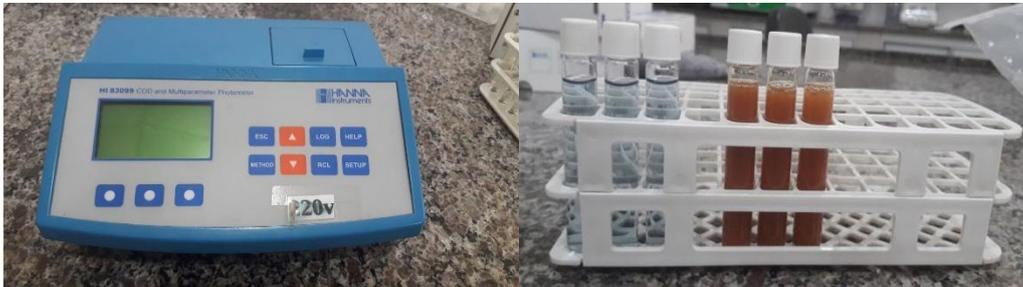
**Figura 3. A) Equipamento utilizado para as análises de fósforo e amônia; B) Amostras com reagentes para devida caracterização.**
