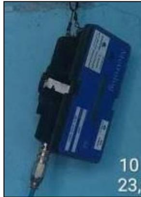
**Figura 14: Detalhes do local de instalação do Datalogger - Ponto 2 de Pressão.**
