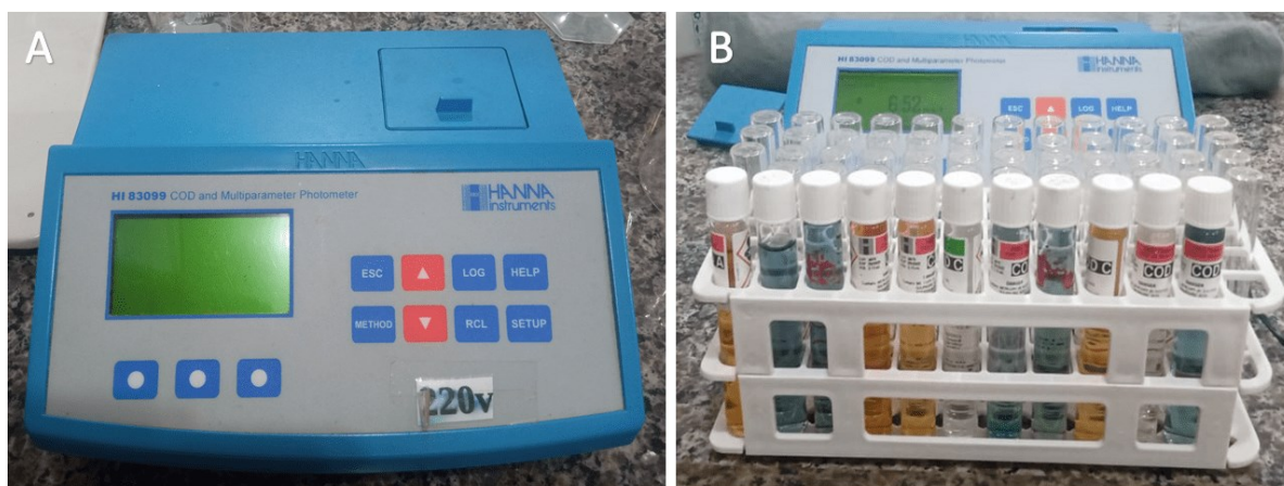
Figura 3A: Aparelho utilizado para realizar as análises de fósforo e nitrogênio; 3B: Cubetas após a leitura das análises de fósforo e nitrogênio. Fonte: direta, 2023.
