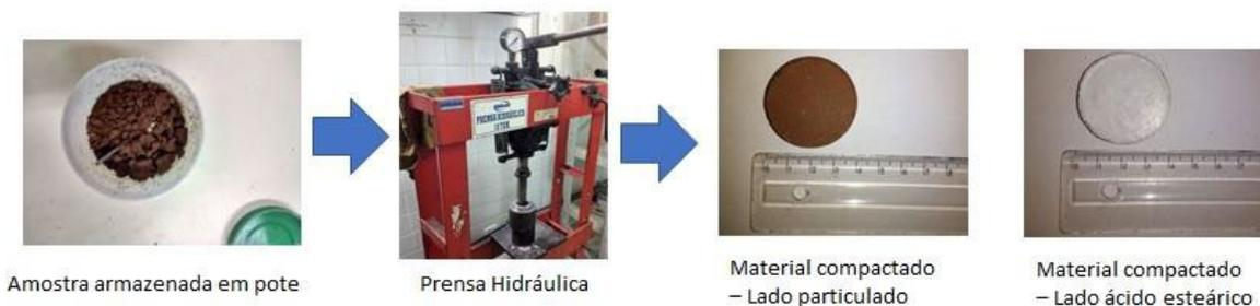
**Figura 2. Processo de compactação do material coletado para análise da composição.**
