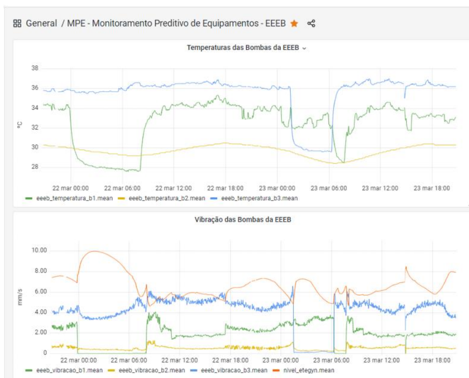
Figura 3: Gráficos de vibração e temperatura das bombas da ETE Dr. Hélio Seixo de Brito.
