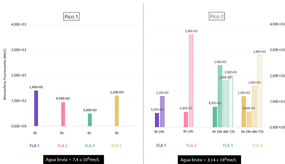
**Figura 7 - Concentração de microesferas na água efluente dos filtros durante os ensaios realizados na Fase experimental 1**
