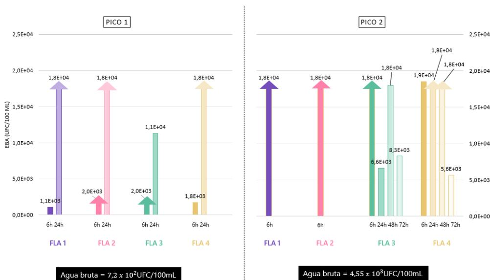
**Figura 8 - Concentração de EBA na água efluente dos filtros durante os ensaios realizados na Fase experimental 1**
