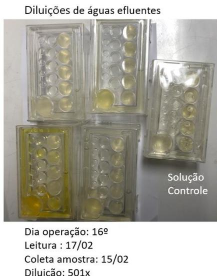
**Figura 5 – Comparação de diluições no dias de operação das águas efluentes**
