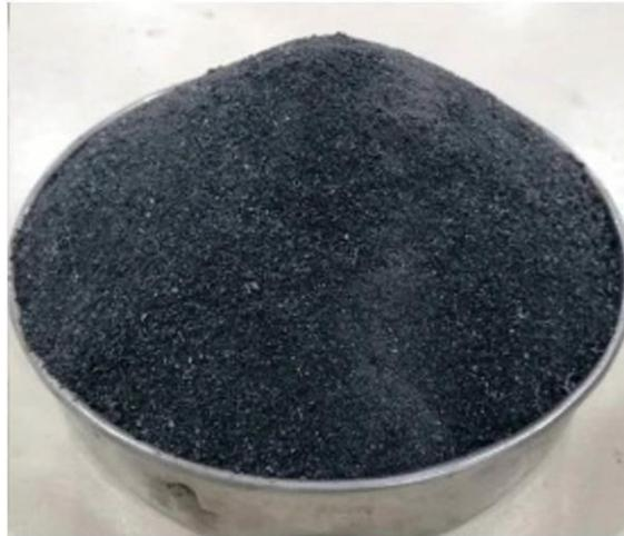
**Figura 4: Agregado miúdo de ABS. Fonte: Ali et al. (2021)**
