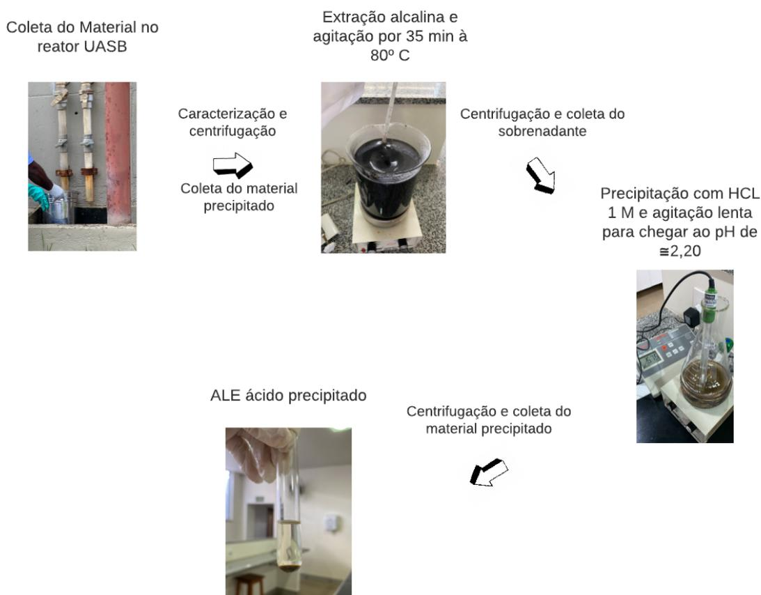
Figura 1 – Esquema de extração de EPS e ALE com base em Felz *et al.* (2016).
