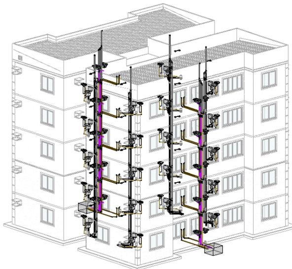
Figura 3: Isométrico do Sistema Predial de esgoto sanitário (3D).
