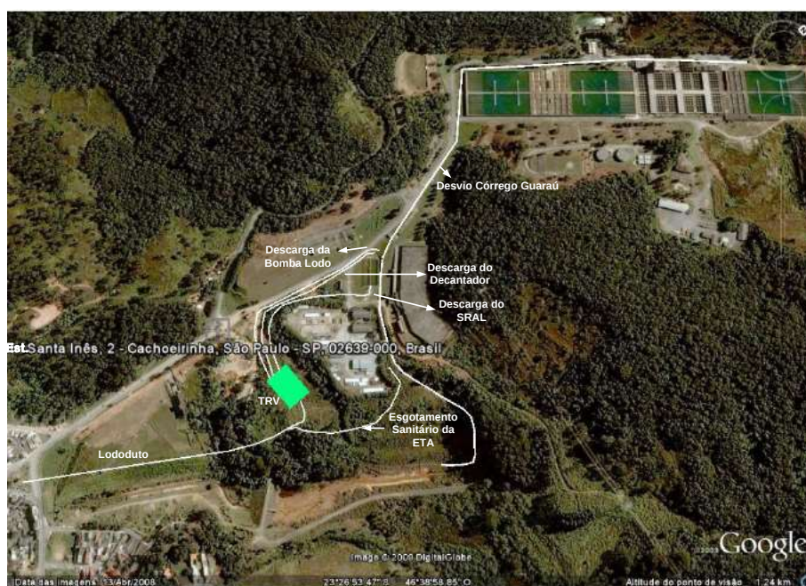
Figura 2 – Vista geral da ETA –com esboço das adequações necessárias para o sistema de lodo
