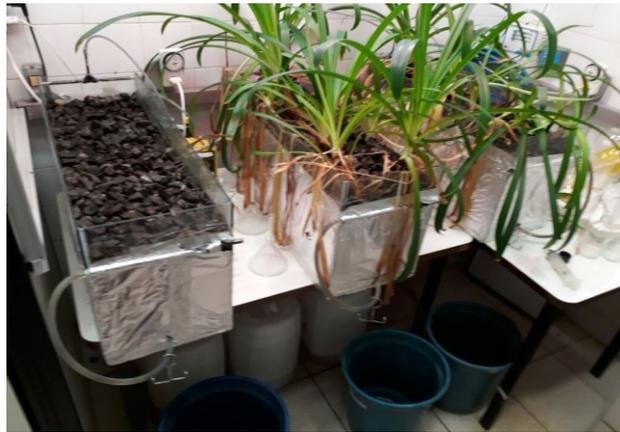
**Figura 1b** - Sistema piloto de Tratamento CWs com plantas em estágio avançado de desenvolvimento, CW1 (branco sem plantas 1º da esquerda para direita).
