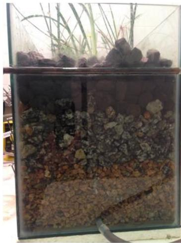
**Figura 2** - Sistema piloto de Tratamento WCs com meio suporte estratificado com três tipos de britas: Brita 0, Brita 1 e Brita 2, no sentido de baixo para cima.
