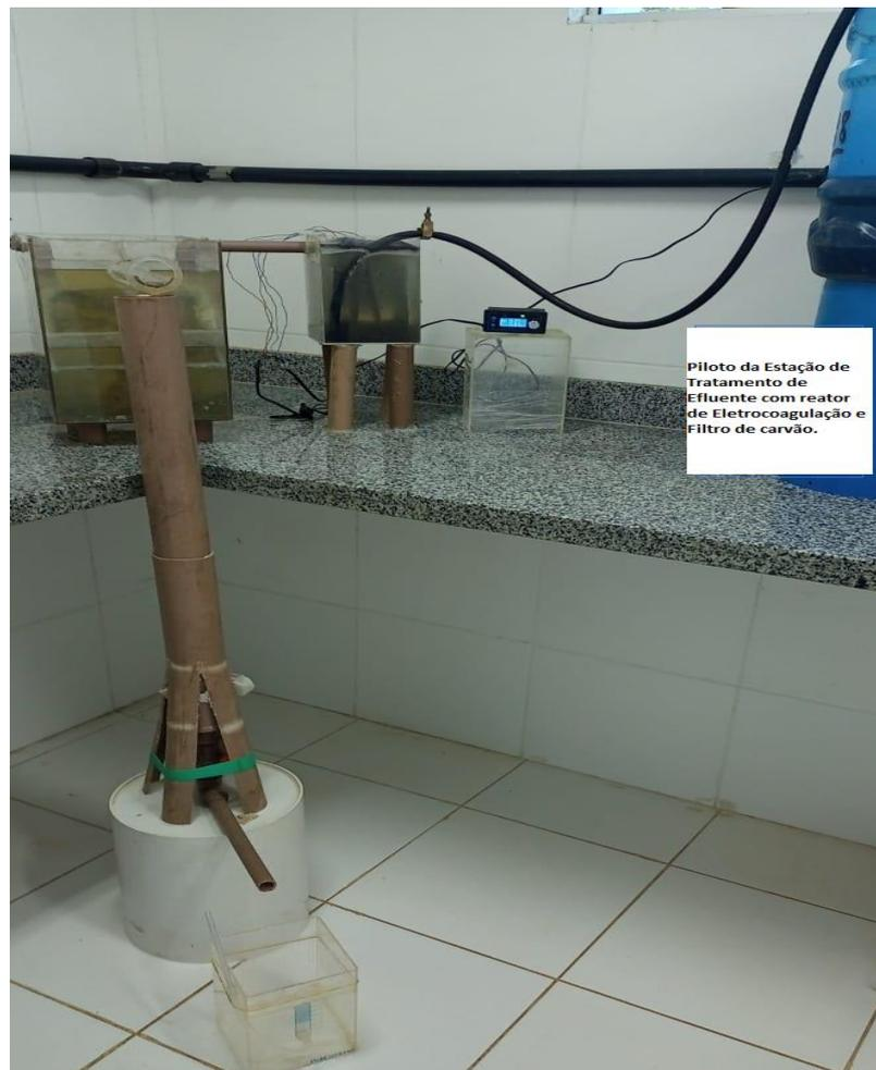
**Figura 6: Piloto da Estação de Tratamento de Efluente com EC.**
