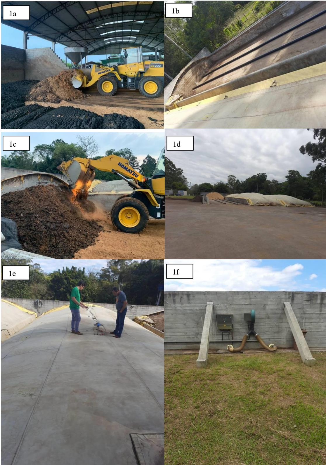
**Figura 1: a) leira vazia b) lodo com material estruturante sendo colocado na leira c) leira já fechada e coberta com as membranas semipermeáveis, d) sensores de temperatura e oxigênio e) sistema de aeração.**
