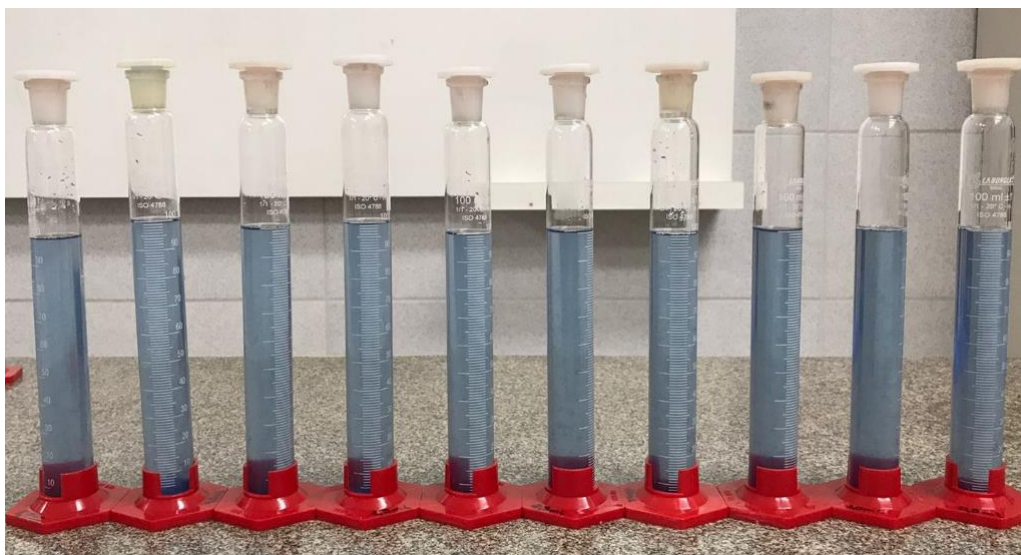
Figura 2: Ensaios de adensamento por gravidade em provetas com diferentes tipos de polímeros.
