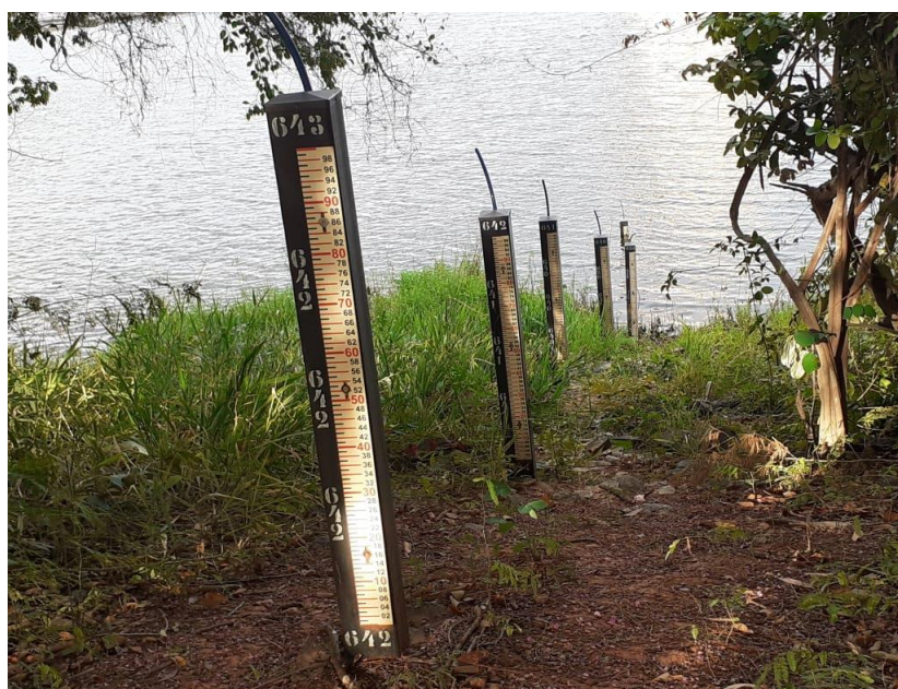
Figura 03 - Régues instaladas na torre de captação.
