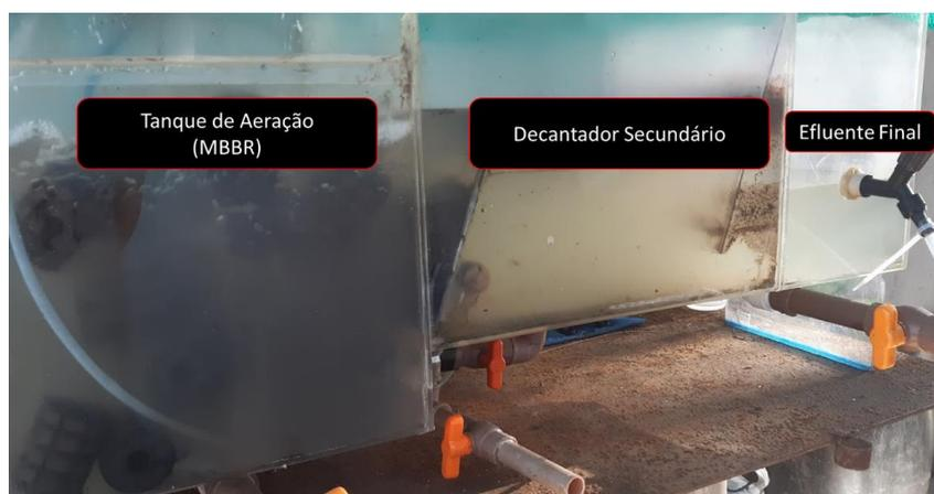
**Figura 2: Reator MBBR operado de forma contínua.**
