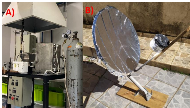
Figura 1: Fotografia dos reatores: a) Pirolisador convencional e b) Pirolisador solar.
