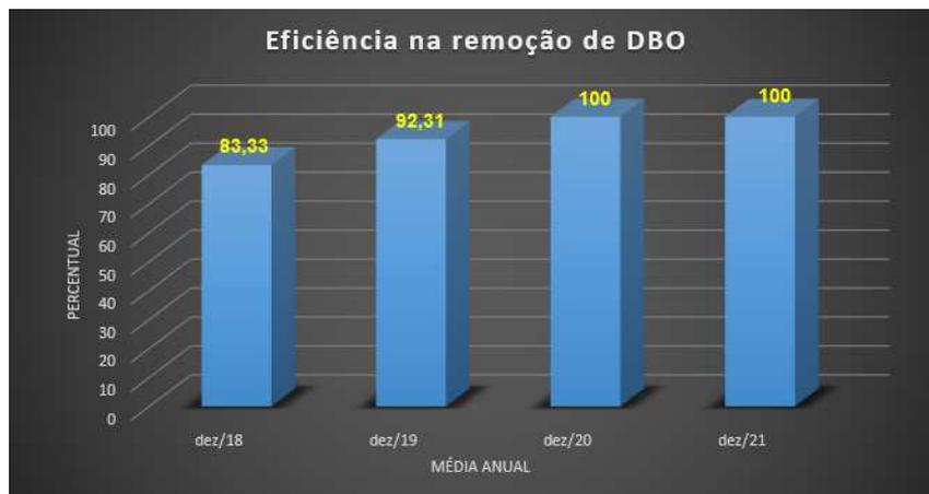
Figura 7 – Gráfico do indicador Eficiência na Remoção de DBO – GRJA.
