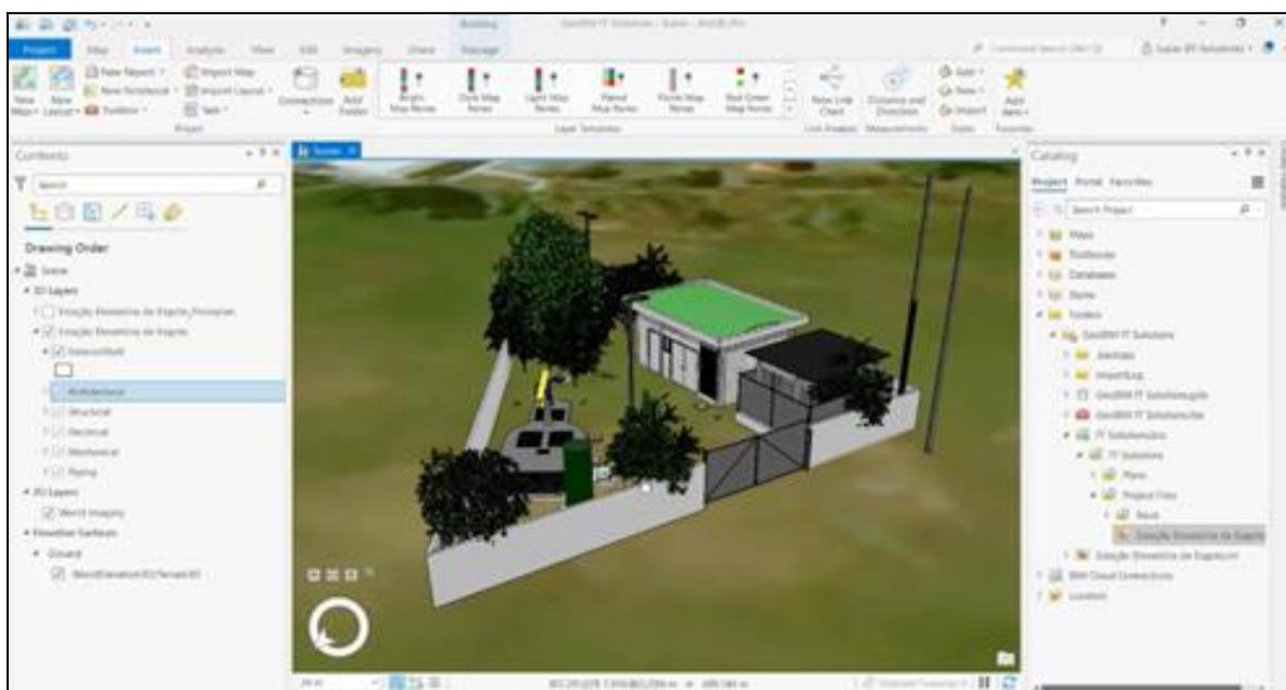
**Figura 2: Modelo BIM da Estação Elevatória Fazendinha, carregado a partir de seu arquivo original armazenado no Autodesk Docs. Fonte: FF Solutions.**
