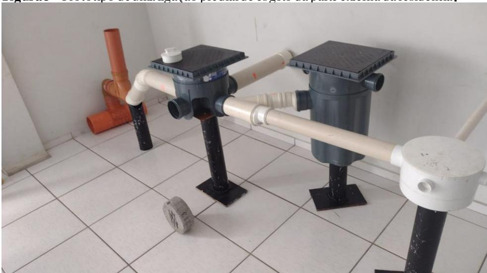
**Figura 4 .** caixa d'água de 100 litros e uma caixa de descarga, cortadas em perfil
