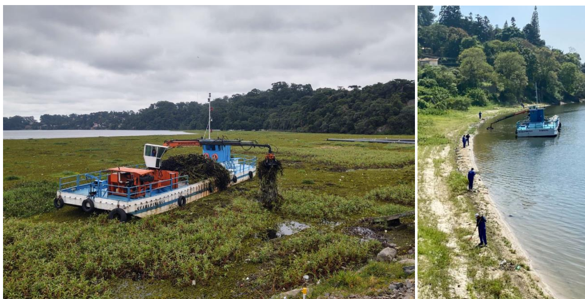
Figura 3: Barco com braço mecanizado recolhendo macrófitas próximo a barragem Guarapiranga e equipes coleta manual de lixo atuando as margens da represa.
