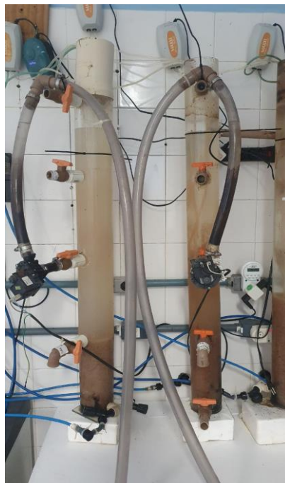
Figura 1: Reatores utilizados na pesquisa, R1 (controle) no R2 (adição de NaCl).
