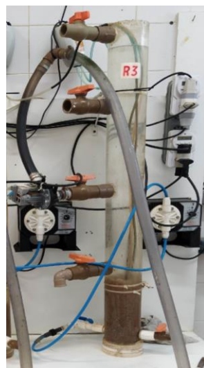
Figura 2 – Reator de Lodo Granular Aeróbio
